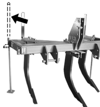
**NOTA:** Pudiera ser necesario alargar el brazo central. Si lo extiende, asegúrese de reajustar el brazo central de enganche de acuerdo a la longitud especificada (en la sección de Preparación del Tractor).
