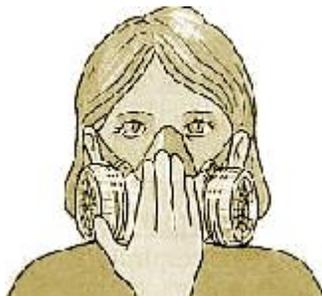
**Prueba de presión negativa-** Bloquee la rejilla o rejillas de inhalación con las palmas de las manos (como se indica en el dibujo) inhale lentamente durante 10 segundos. Si la mascarilla se colapsa ligeramente y no detecta fuga de aire entre su cara y la mascarilla, se ha obtenido un ajuste apropiado.
