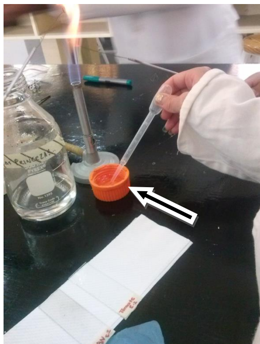
Figura No. 4 “Tomando con la pipeta agua destilada para colocar una gota en el portaobjetos”.
