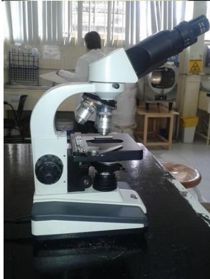
Aquí observamos el microscopio de perfil se ve claramente todas las partes utilizadas, como la platina en la que colocamos algunas células y con los tornillos macro y micro ajustamos el enfoque, el revólver de lentes con los que vimos a diferentes distancias.
