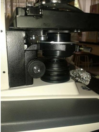
En esta imagen podemos ver claramente los tornillos de ajuste el condensador, la platina y la base.
