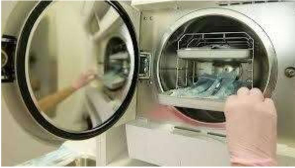
Se nos mostró el uso de esta maquina llamada autoclave que sirve para esterilizar materiales y se nos dio a conocer como se usa.
