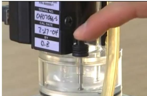
2. Observe que la burbuja (correctamente formada) pase por el segmento superior del sensor, para tener la certeza de que la prueba es efectiva. De no ser así se elimina el valor obtenido.
