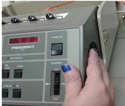
13. Para seccionar la intensidad (dB), gire el aro ubicado en la parte lateral izquierda del equipo, la intensidad seleccionada aparecerá en la pantalla lateral izquierda.
