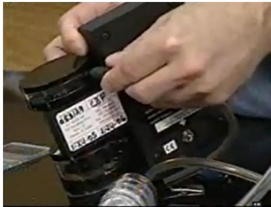
7. Coloque la manguera flexible que está conectada a la cara estriada del casete de muestreo (oulet/rojo, salida del aire).
