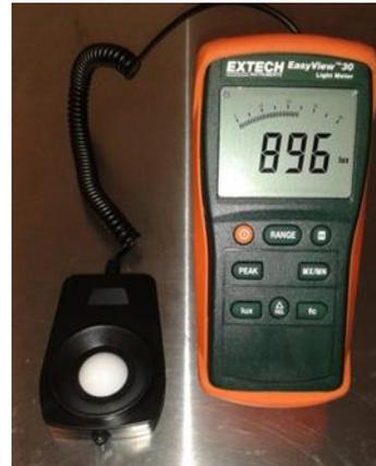
6. Si la medición está fuera de escala, en la pantalla aparecerá la leyenda **"OL"**, debiendo seleccionar otra escala presionando el botón **"RANGE"** del equipo.
