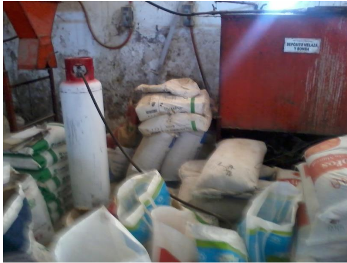
Cilindro de gas mal ubicado en el interior de la nave
