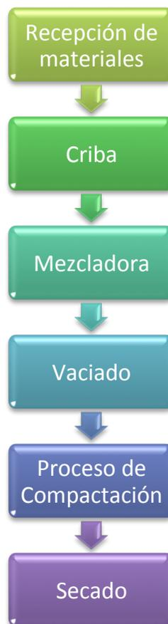
Las máquinas producen hasta treinta y ocho mil cuatrocientos (38.400) ladrillos por turno de ocho horas, para esta producción se necesita únicamente de dos a
